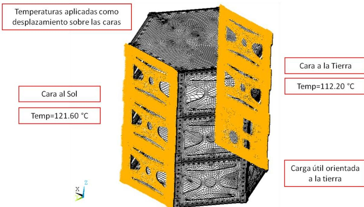
**Ilustración 33: Condición de Frontera de Temperatura de la Estructura Configuración Hexagonal**
