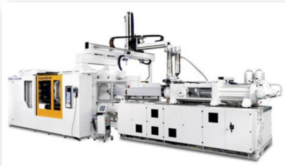
**Figura 4. Máquina inyectora Krauss Maffei de 350 Toneladas.**
