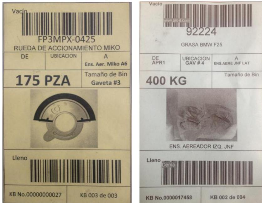
**Figura 27. Tarjetas kanban de componentes.**
