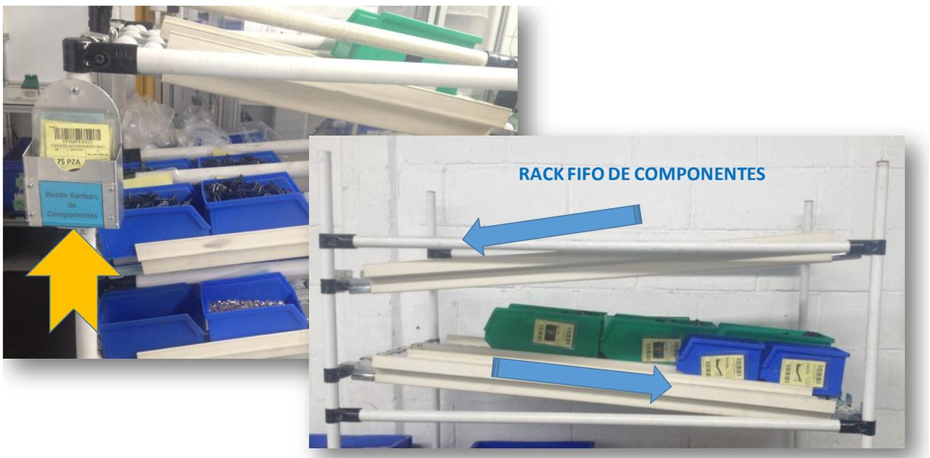
**Figura 26. Suministro de materiales a la línea de producción mediante kanban.**
