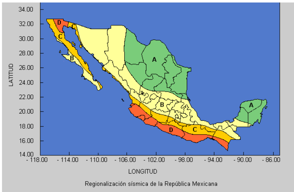
Figura 1.10 regionalización sísmica de México refleja la frecuencia de los sismos y la aceleración máxima del suelo. El estado de Tlaxcala se ubica en la zona B.
