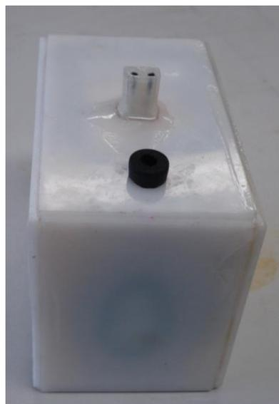
Figura 7.32. Carcasa del actuador de pulso.
