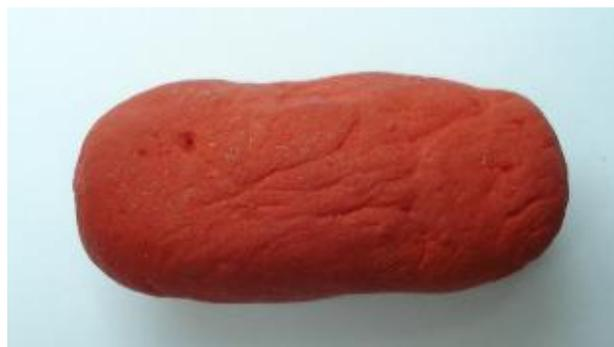
Figura 7.29. Imán permanente recubierto de resina, objeto extraño.
