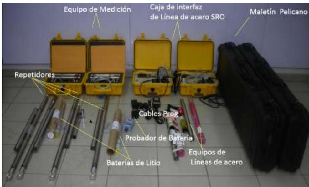
**Figura 3.12. Equipo de Telemetría Acústica Avanzada**
