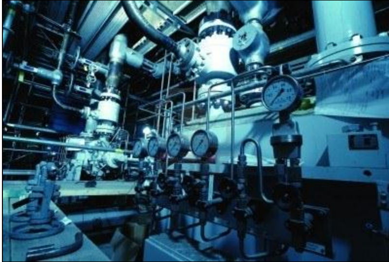
Figura 5.8 Los manómetros son indispensables en el control de brotes en aguas profundas, prácticamente son nuestros ojos a miles de metros de profundidad.
