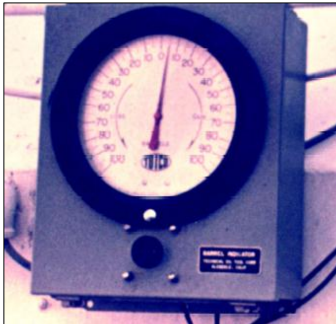
Figura 5.3 Totalizador de volumen de presa de lodos.
