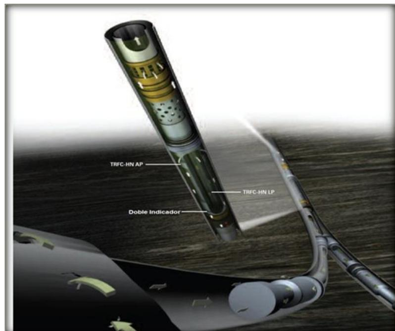
**Figura 4.2 – Válvulas TRFC-HN AP y TRFC-HN LP trabajando en combinación para controlar la producción desde dos zonas<sup>1</sup>.**
