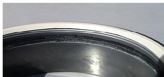
**Figura 4.28** – Asiento de estrangulador por erosión (izquierda) y diseño mejorado (derecha) después de una prueba de vida acelerada con un flujo de arena del 2 al 3% en un volumen a 70 kg/cm<sup>2</sup> aproximadamente<sup>10</sup>.
