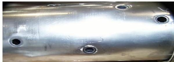
**Figura 4.27** – A la izquierda, diseño anticipado de un estrangulador de fondo dañado por erosión en una prueba de vida acelerada. A la derecha, diseño mejorado sujeto a la misma prueba de erosión<sup>10</sup>.
