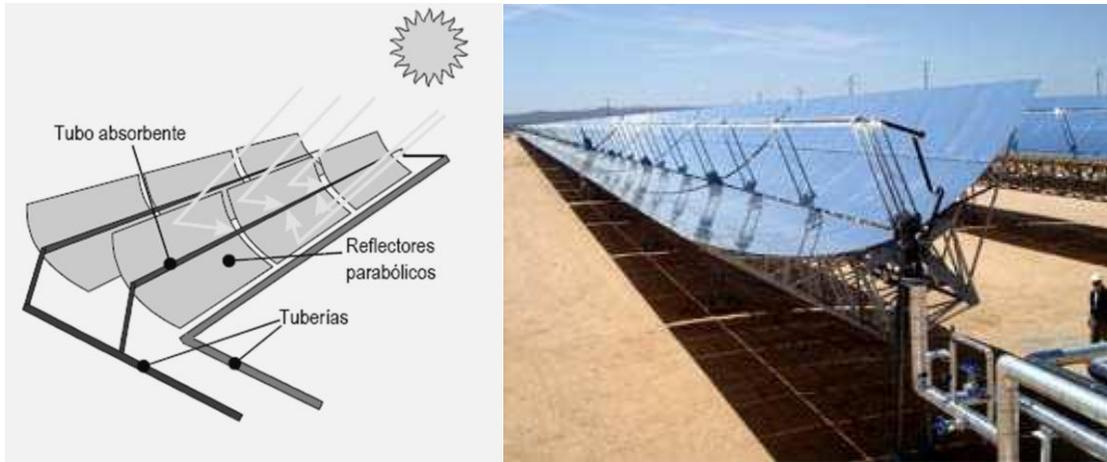
Figura No. 2.23 Colectores cilindro-parabólicos de alta temperatura.
