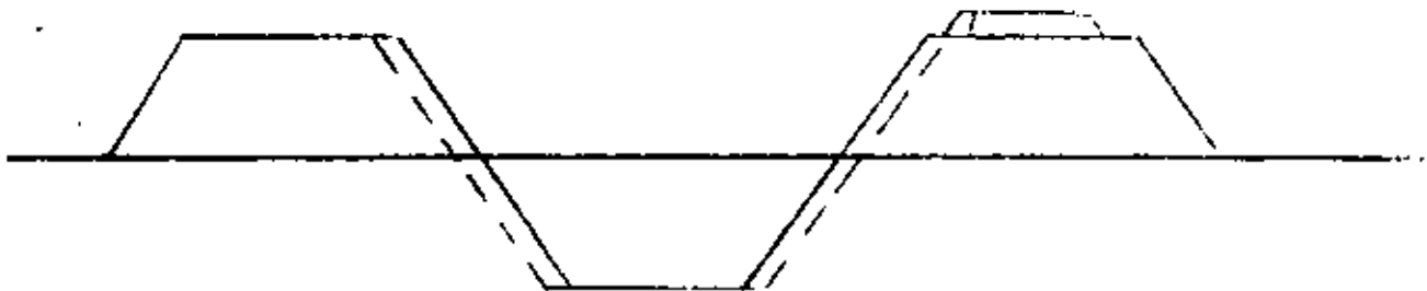
III.- Excavación de cubeta con espesor.
