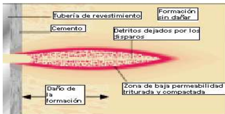
Figura 3.6.- Los disparos crean un túnel en el pozo.(Behrmann L. 2004)
