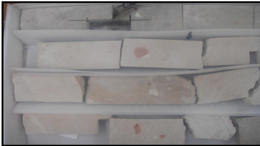
Figura 3.28 Cambios de coloración después de aplicar Rojo Alizarina en el intervalo [934.43 - 936.80] [m].
