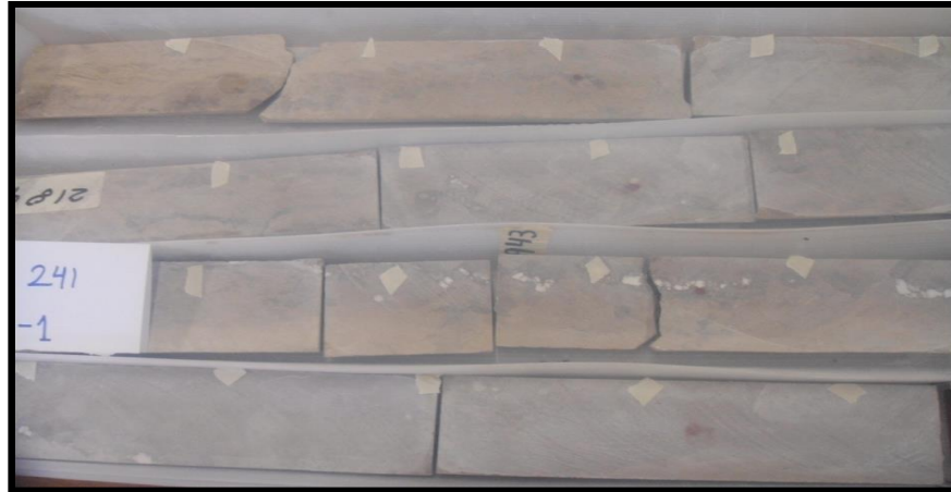
Figura 3.26 Cambios de coloración después de aplicar Rojo Alizarina en el intervalo [929.42-932.32] [m].
