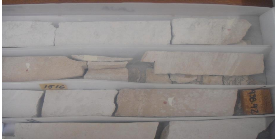
Figura 3.29 Cambios de coloración después de aplicar Rojo Alizarina en el intervalo [936.8 - 938.96] [m].
