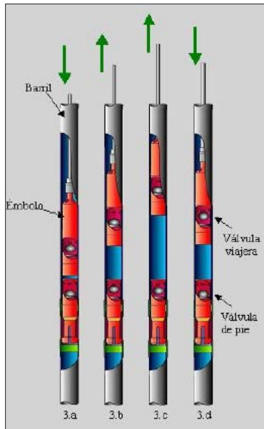
Fig. 3.20 Ciclo de la bomba reciprocante de BM
