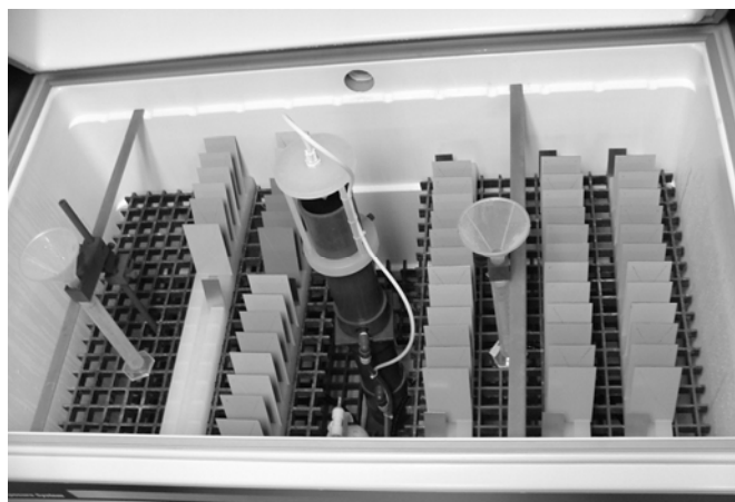
Figura 14 Distribución aleatoria de las probetas de prueba.
