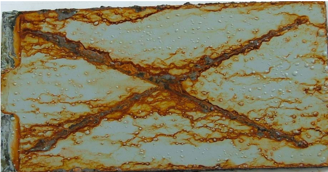
Figura 21 Comparación visula de la probeta 2, con la plantilla 4 del porcentaje de oxidación.
