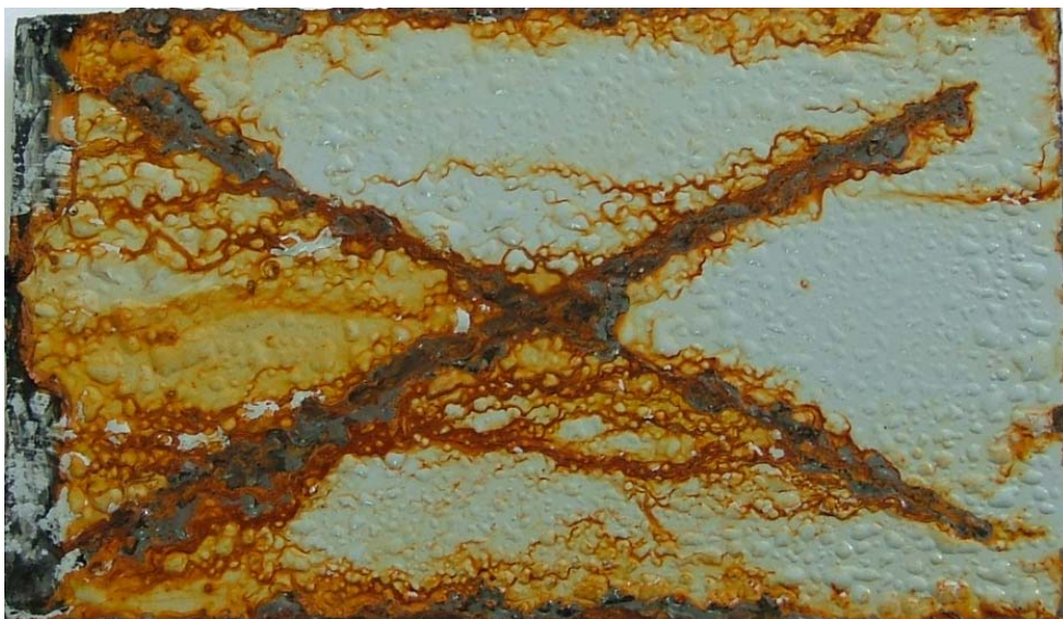
Figura 20 Evaluación de la oxidación de la probeta 14.
