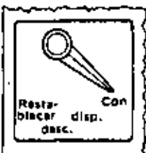
Posición de "CONECTADO": La manija se está en esta posición cuando el circuito está "cerrado".
