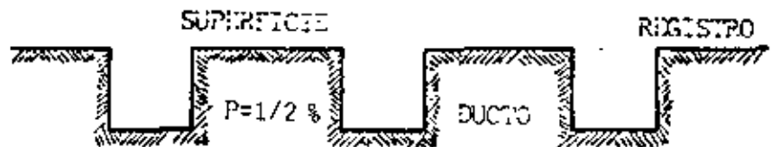
DISPOSICION CORRECTA DE LA PENDIENTE EN DUCTOS
