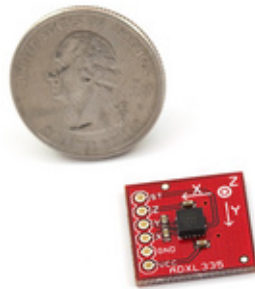
(a) Acelerómetro ADXL335
