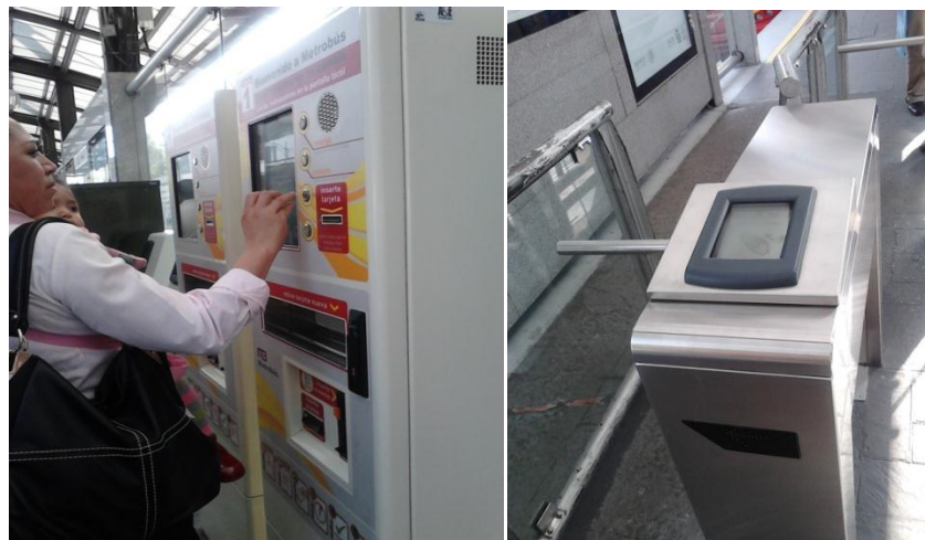
Ilustración 83 Máquina para recargar la tarjeta y torniquetes del sistema Metrobús
