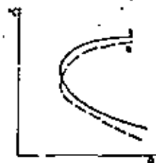
Figura 3.33: Traslapa de las curvas de inicio de transformación de la perlita (a) y de la bainita (b)
