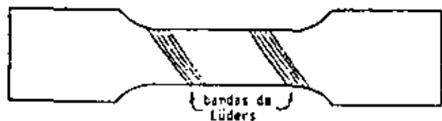
Figura 235 : Representación esquemática de la aparición de Bandas de Lüders en una probeta deformada por prueba de tracción
