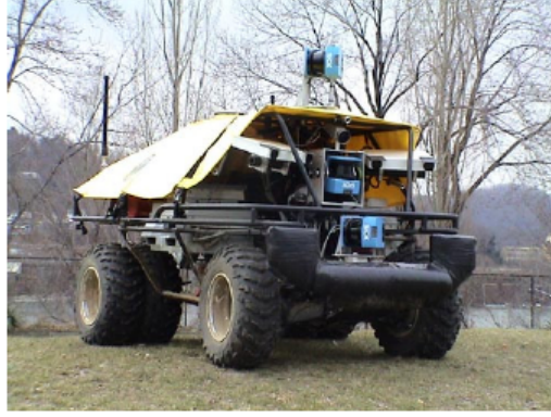
Figura 1.0.1: Vehículo autónomo usado por Nistér en su trabajo de odometría visual. Cuenta adelante con dos sistemas de cámaras estéreo que se usan para aumentar la estabilidad del algoritmo.
