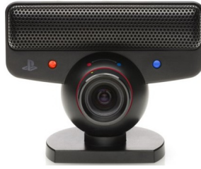
Figura 4.1.1: Cámara PlayStation Eye usada para tomar las fotografías en los experimentos. Puede tomar fotos con una resolución de 640 x 480 píxeles a 60 Hz o fotos de 320 x 240 píxeles a 120 Hz. Además cuenta con dos zooms ajustables.
