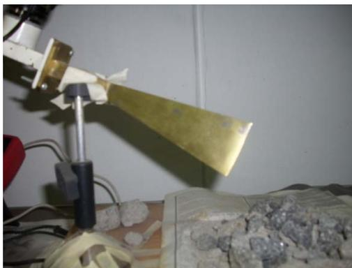
Figura 3.6 Fotografía de uno de los sensores utilizados en el laboratorio para aplicar la señal de microondas sobre la muestra de concreto fresco.
