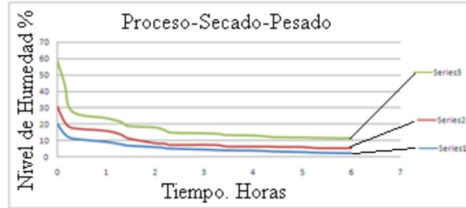
Figura 4.36. Grafica que muestra el proceso de pesado secado pesado para las tres opciones de relación agua cemento utilizadas en las pruebas de humedad en concreto fresco. Datos tomados en las primeras seis horas de fraguado.
