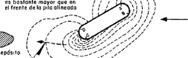
La máxima socavación se presenta en la esquina C y es bastante mayor que en el frente de la pila alineada
