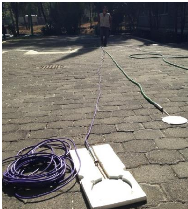
Figura 31. Colocación de ducto de protección a los cables de los instrumentos
