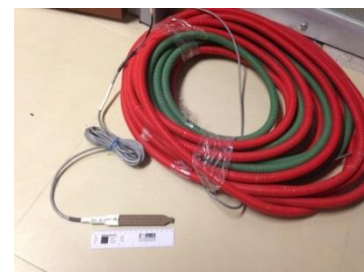
Figura 31. Colocación de ducto de protección a los cables de los instrumentos
