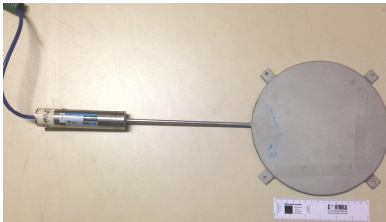
Figura 22. Celda de presión con transductor de cuerda vibrante
