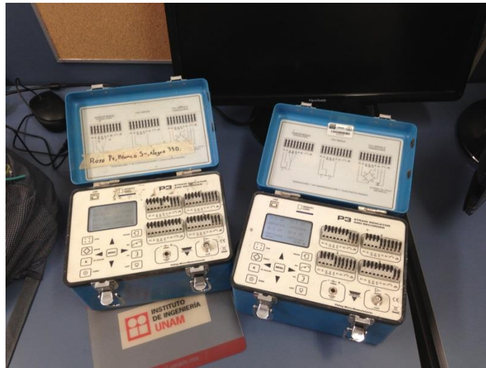
Figura 19. Consola lectora para adquisición de datos de deformaciones, P3- Vishay
