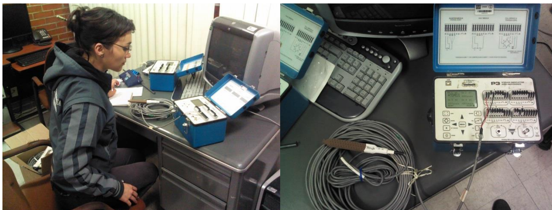
Figura 29. Toma de lecturas iniciales de deformímetros de un cuarto de puente
