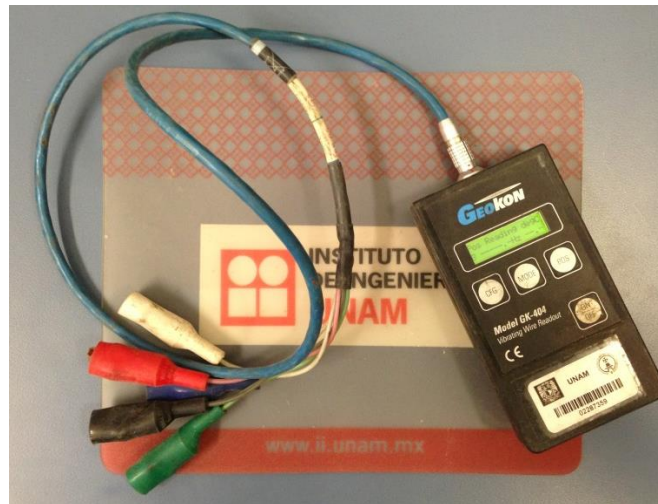
Figura 23. Consola lectora para adquisición de datos de frecuencia y temperatura
