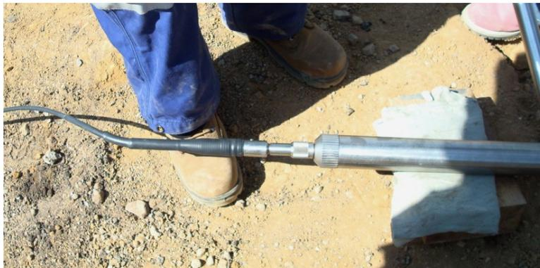
Figura 9. Cable head conectado a la sonda
