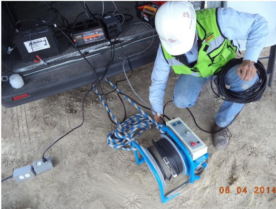
Figura A7. Conexión del cable que sujeta la sonda suspendida
