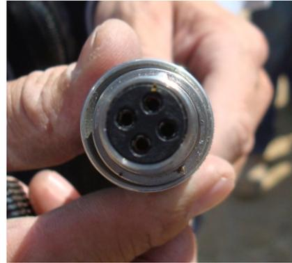
Figura 8. Cable head. Conexión del malacate hacia la sonda
