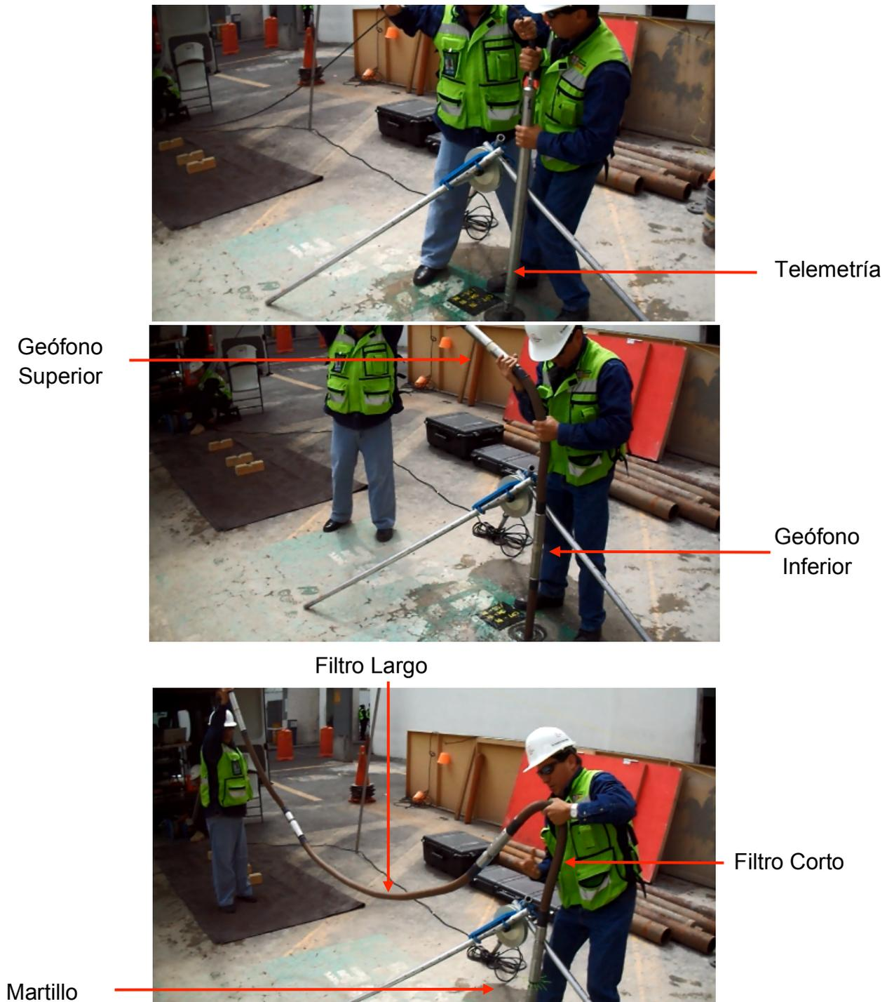
Figura 17. Colocación de la Sonda Suspendinga en el pozo.
