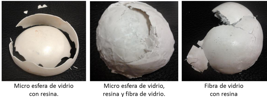
Figura 7.4 Carcasas al terminar la prueba de compresión.
