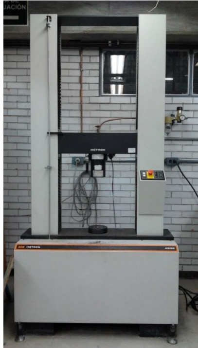
Figura 6.1 Máquina INSTRON para la realización del ensayo de compresión.
