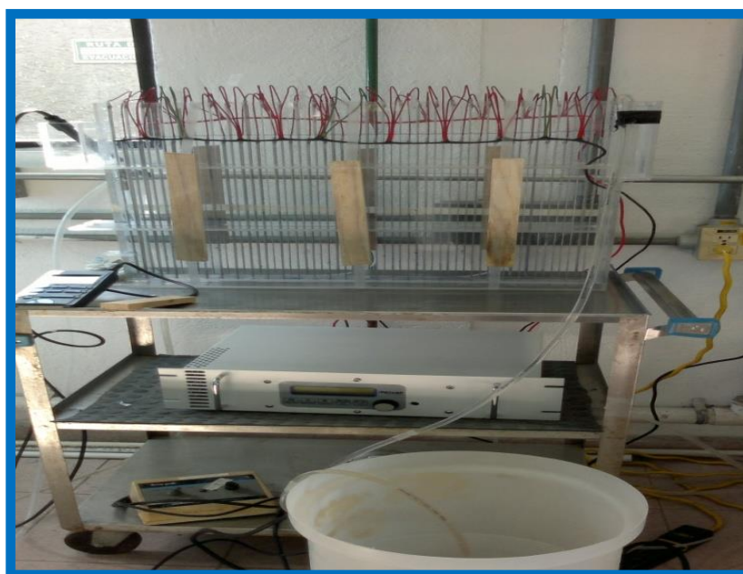
Fig. 3.3.- Reactor electroquímico armado y acoplado a la fuente de poder programable
