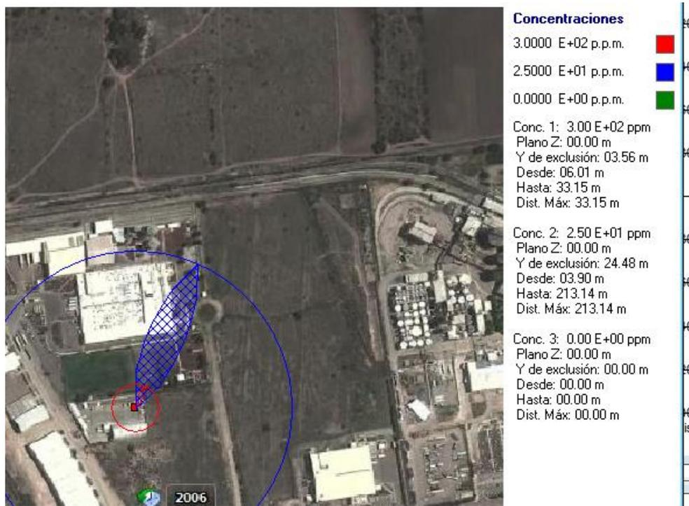
Figura 6.26 Vista geográfica de área afectada por fuga de amoniaco en empresa productora y comercializadora de alimentos
