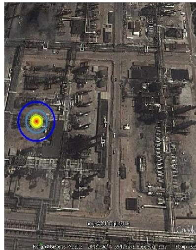
Figura 6.6 Vista geográfica de los radios de afectación del compresor 3
