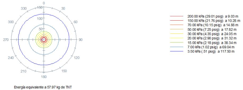
Figura 6.15 Radios de afectación del compresor 8
