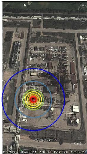
Figura 6.10 Vista geográfica de los radios de afectación del compresor 5
