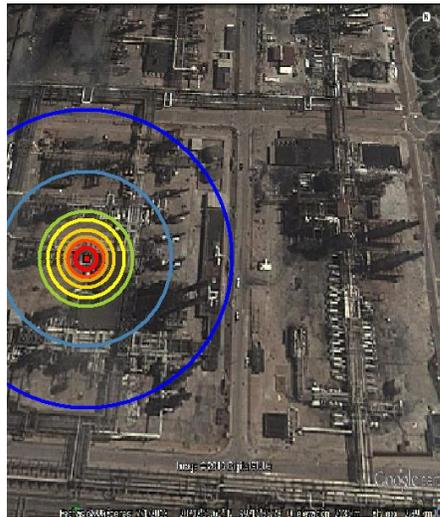
Figura 6.4 Vista geográfica de los radios de afectación del compresor 2.
