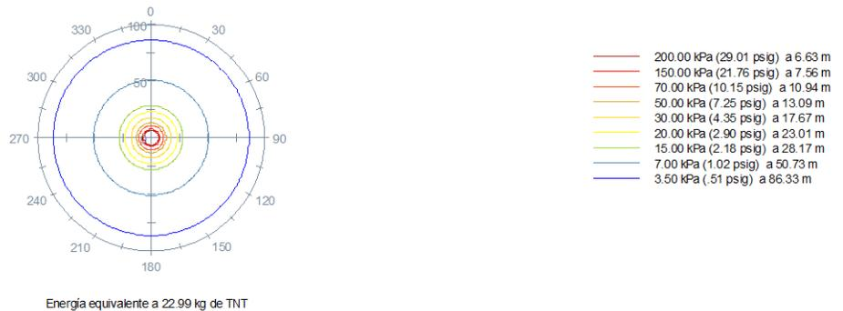
Figura 6.11 Radios de afectación del compresor 6
