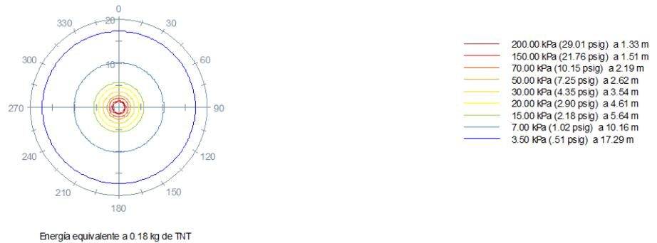
Figura 6.21 Radios de afectación del compresor 13
