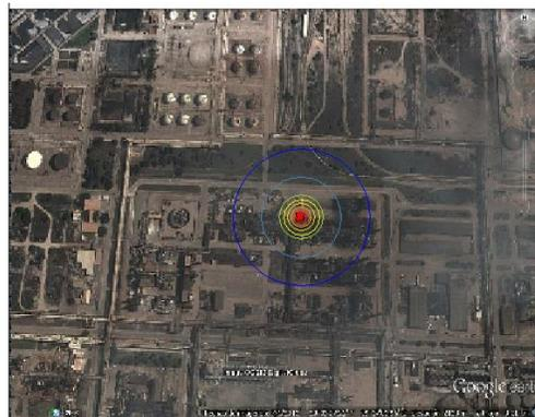
Figura 6.16 Vista geográfica de los radios de afectación del compresor 8
