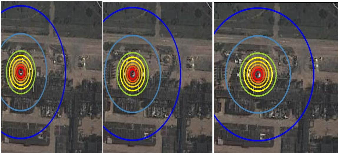
Figura 6.18 Vista geográfica de los radios de afectación del compresor 9, 10 y 11
