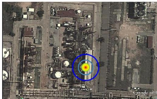
Figura 6.14 Vista geográfica de los radios de afectación del compresor 7
