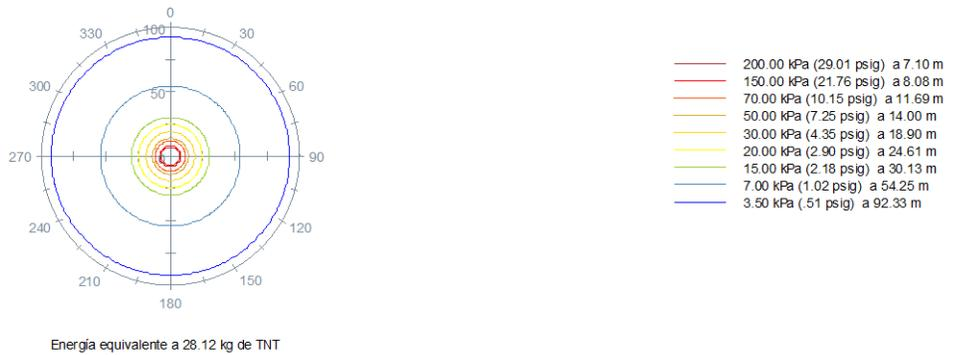
Figura 6.9 Radios de afectación del compresor 5
