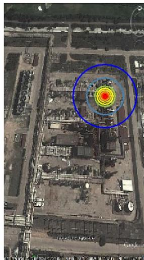
Figura 6.8 Vista geográfica de los radios de afectación del compresor 4
