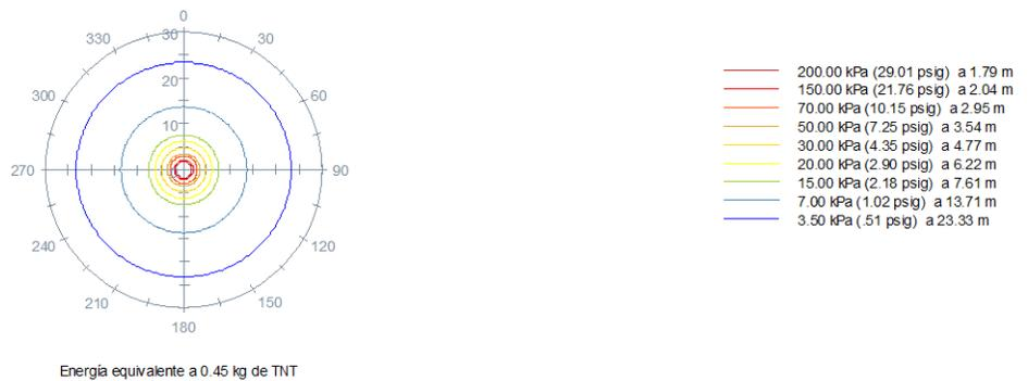
Figura 6.13 Radios de afectación del compresor 7
