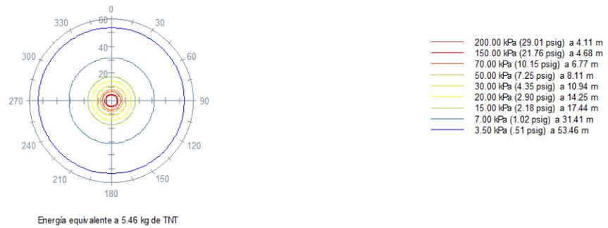
Figura 6.19 Radios de afectación del compresor 12
