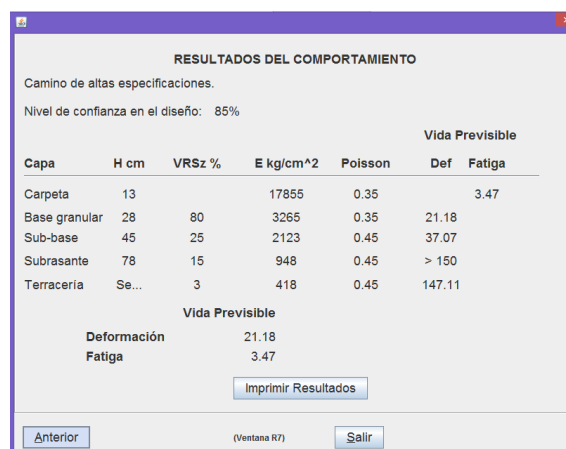
Figura 4.5. Vida previsible del pavimento actual del cuerpo A obtenido con el DISPAV 5 (V3).
