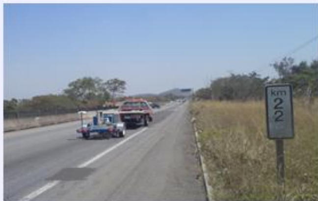
Se observa la obtención de deflexiones con el equipo FWD
