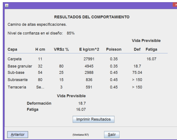
Figura 4.10. Vida previsible del pavimento actual del cuerpo B obtenido con el DISPAV 5 (V3)
