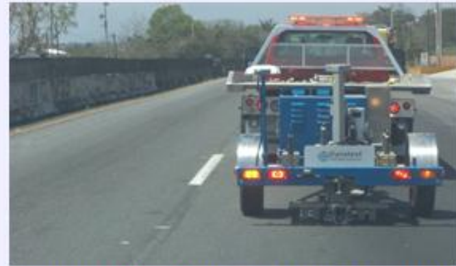
Se observa la obtención de deflexiones con el equipo FWD
