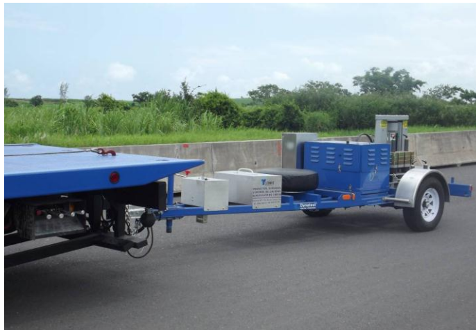
Figura 3.17.- Falling Weight Deflectometer Dynatest (Fuente: Yutave Ingeniería S.A de C.V., .2010).
