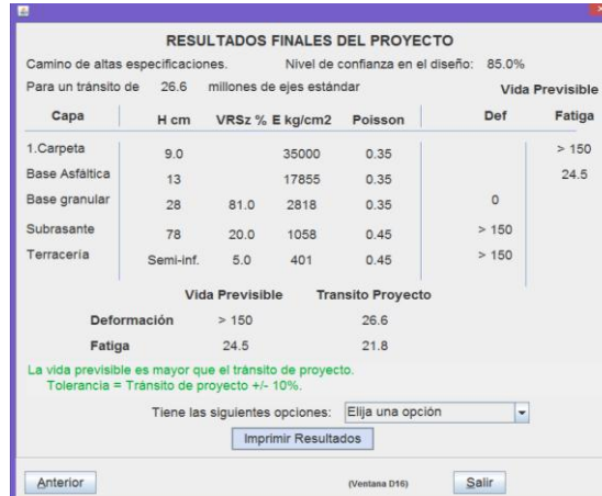
Figura 4.15. Alternativa I del cuerpo A obtenido con el DISPAV 5 (V3) utilizando CBR críticos.
