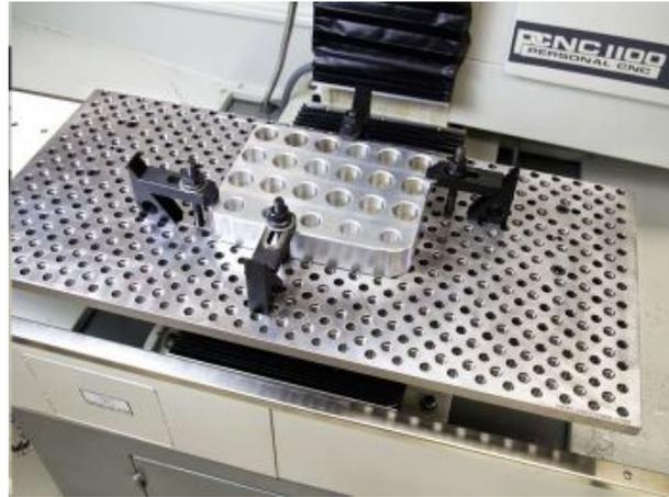
Figura 3.4: *Un tocho fijado a la bancada de trabajo por stops y tornillos.*
