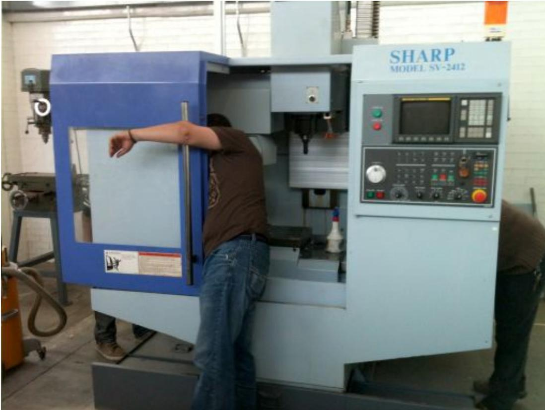
Figura 2.4: La fresadora CNC del taller de mecánica de precisión del IA-UNAM.
