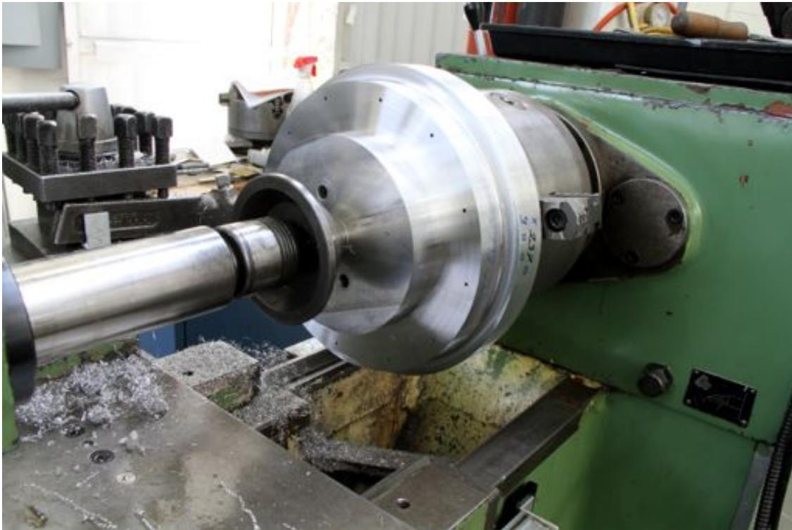
Figura 4.2: *Celda cámara roja C1 montada sobre el torno para ajusta el diámetro exterior al tamaño justo de la interfaz (ver figura 4.3).*
