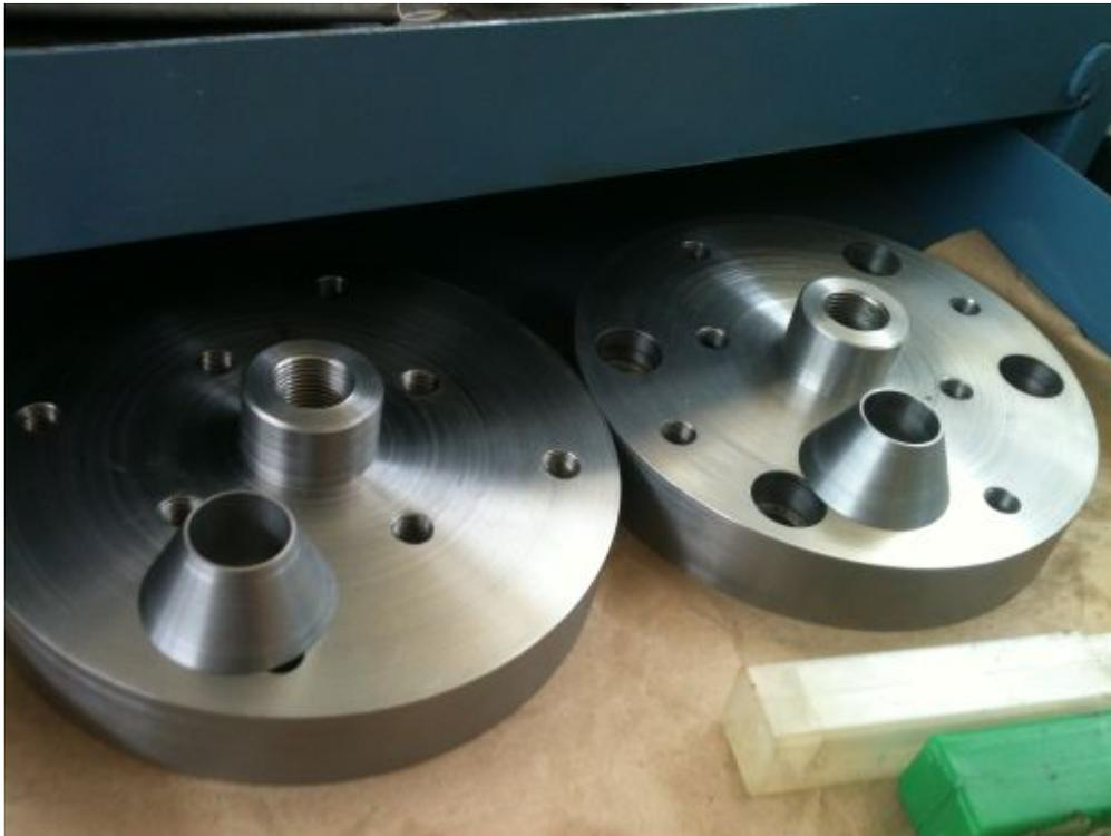
Figura 3.10: *Los dos MUACs terminados con sus respectivos conos de auto centrado. El ejemplar de la derecha está provisto con barrenos y cajones para su montura en la bancada de la fresadora.*
