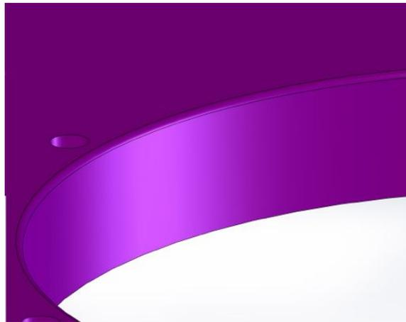
Figura A.22: *Detalle de corte interior, notesé el mate en la parte superior e inferior. Estos cortes se deben hacer en la CNC.*
