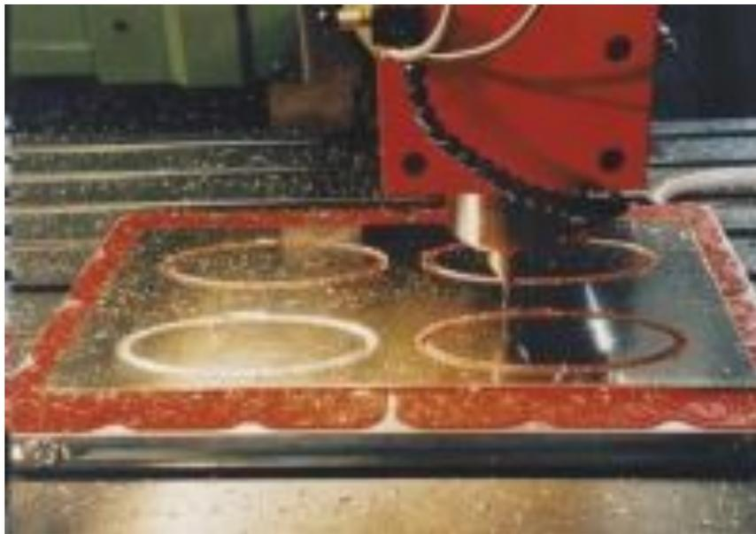
Figura 3.3: *Una pieza plana detenida por vacío.*
