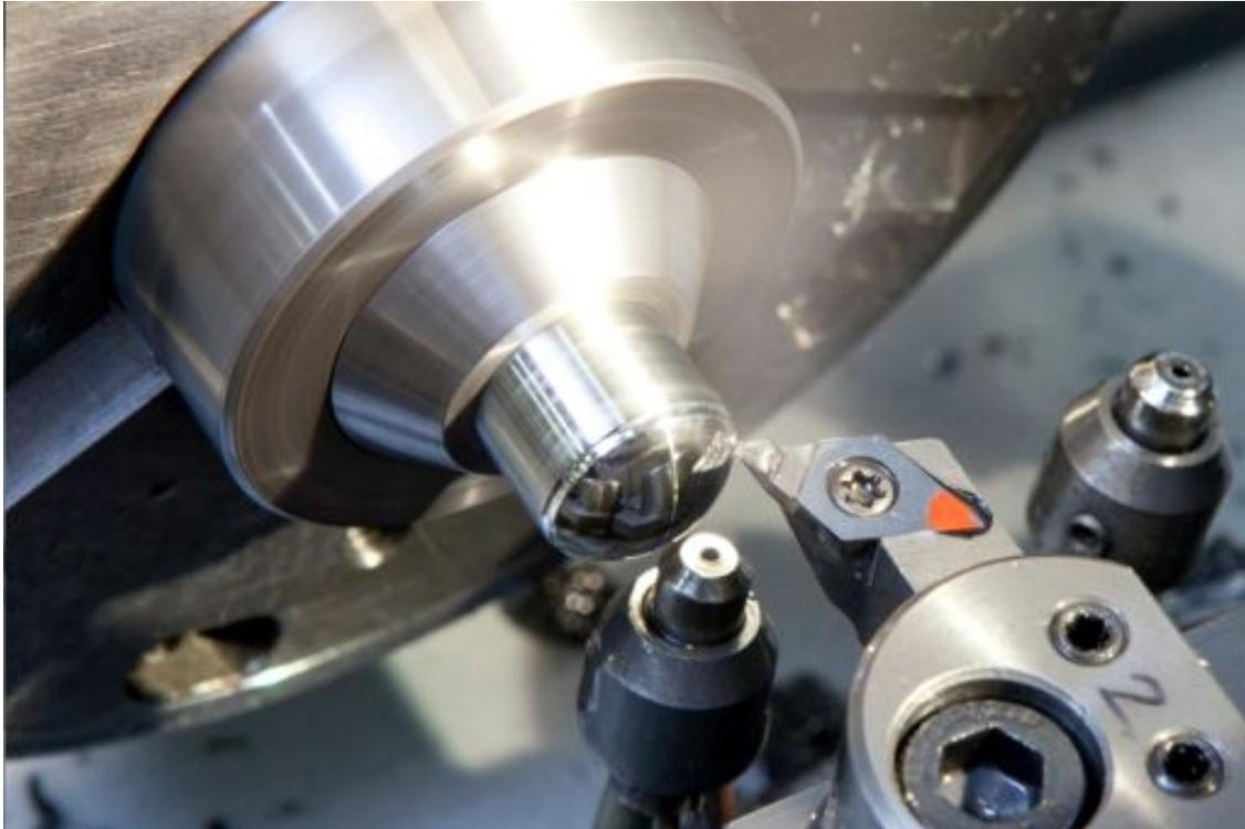
Figura 2.1: *Maquinado de precisión en torno para el molde de un lente de contacto. Los moldes para inyección de plástico o lentes de contacto son de las aplicaciones principales del maquinado de precisión, imagen de Fresnel Technologies ®.*
