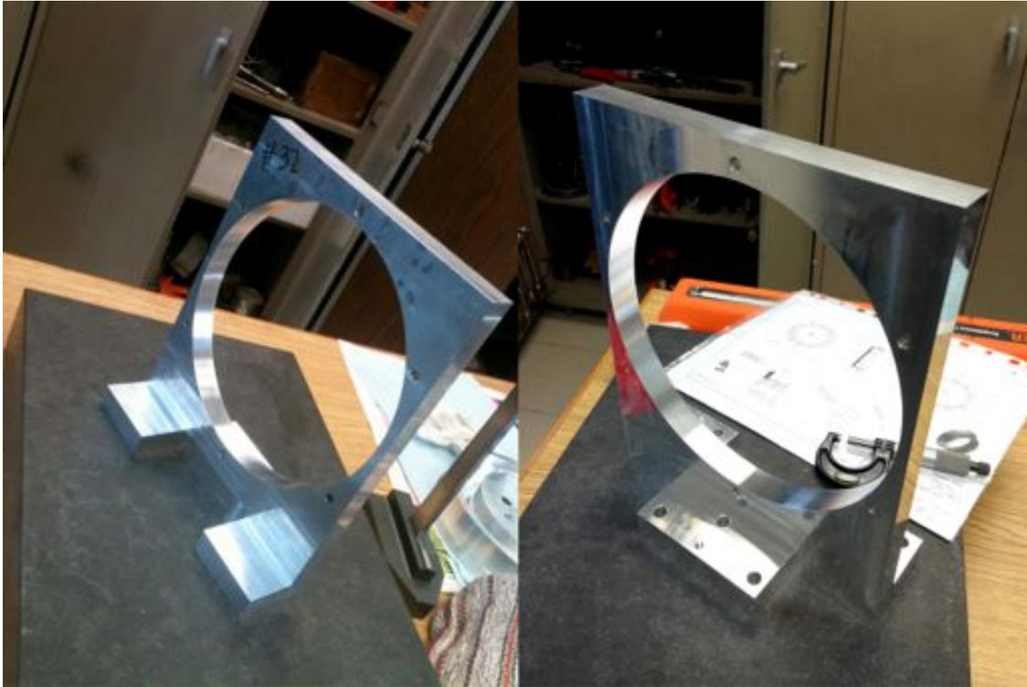
Figura 4.3: *Interfaz barril 1, ESOPO-ME-ICAMR-V1-010-001, antes y después del acabado superficial y barrenos para su montaje.*
