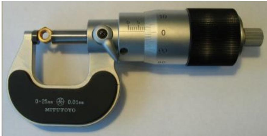
Figura 2.5: Un micrómetro de exteriores. Este tipo de instrumento, como su nombre lo indica, es capaz de medir hasta micrómetros.
