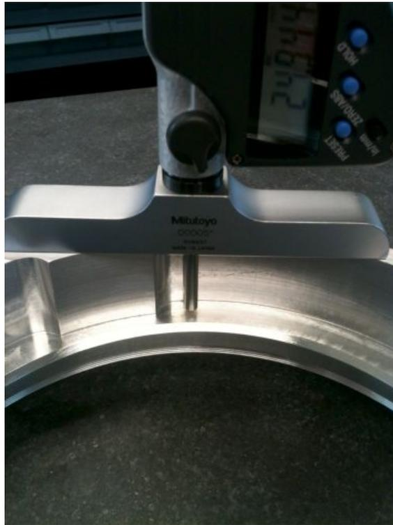
Figura 4.10: *Proceso de medición de ESOPO-ME-CAMR-V1-010-001 con el pie de rey.*
