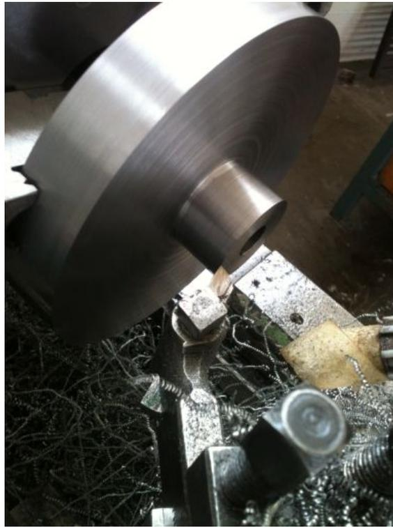
Figura 3.9: *El MUAC montado en el torno del taller mecánico de precisión en sus últimas etapas de fabricación.*
