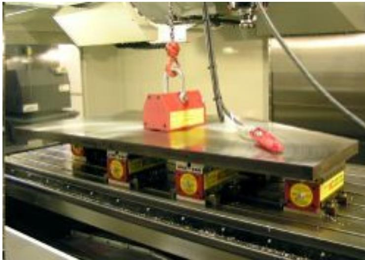
Figura 3.6: *Un arreglo de cuatro prensas magnéticas sosteniendo una placa de acero lista para maquinarse. Se puede ver otro electromagneto acoplado a una pluma para mover piezas pesadas.*
