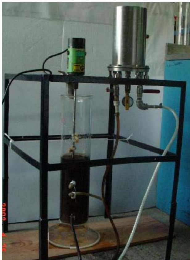
Figura 3.10. Equipo experimental para las pruebas de flotación.
