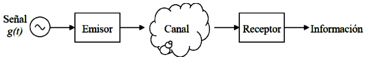
Figura 3: Sistema de Comunicaciones.
