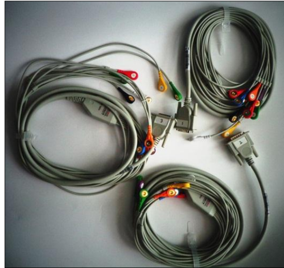
Figura 3.5 Cables de ECG de 10 derivaciones.
