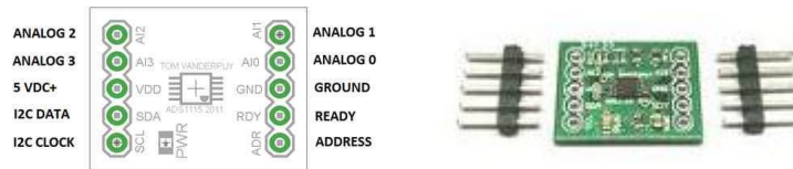
Figura 3.20 PCB de la etapa de conversión A/D.
