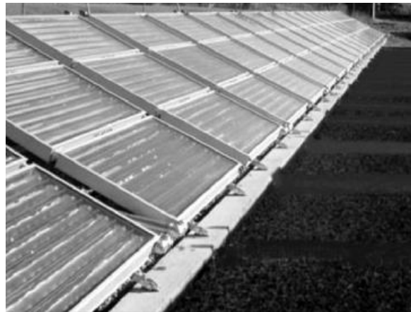
Figura 15. Arreglo de colectores parabólicos compuestos con cubierta de vidrio.
