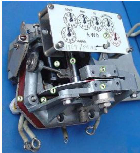
Imagen 19. Medidor de energía eléctrica o wathorímetro
