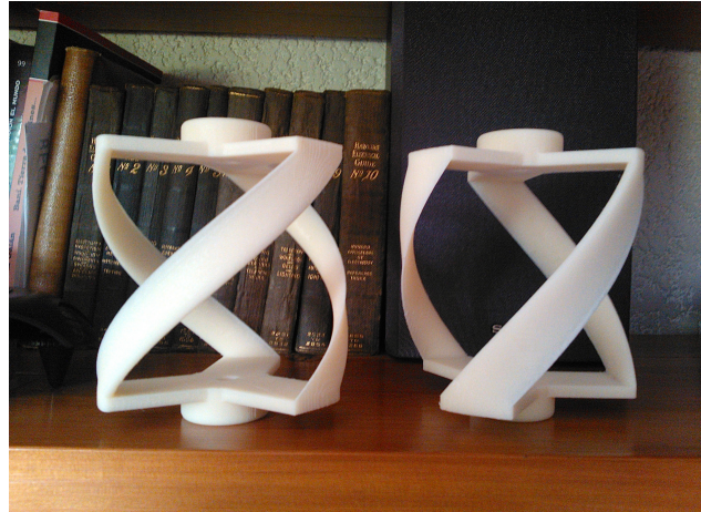
Figura 4.2. Fotografía de los modelos impresos antes de ser lijados y pintados. (120° izquierda, 90° derecha)
