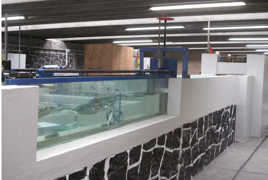
Figura 4.8. Sección de vidrio del canal.
