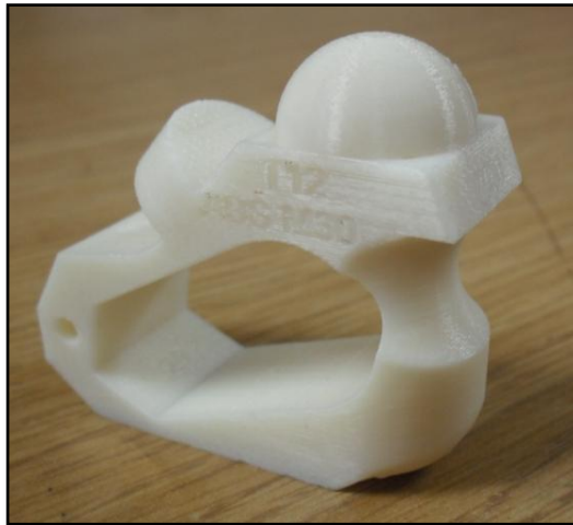
Figura 47. Patrón angular construido con material de modelo ABS-M30 y boquilla T12.
