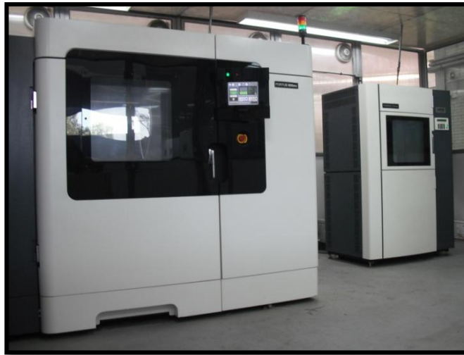
Figura 5. Maquinas Fortus 900mc y 400mc localizadas en el CCADET.
