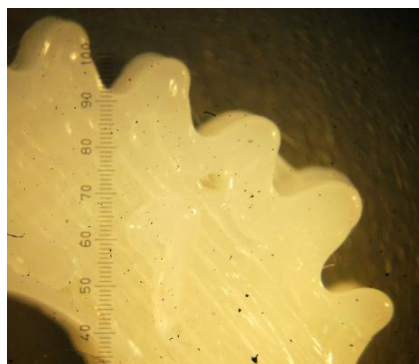
Engrane 1, 1 Contorno Filamentos finos 0.305mm Air gap: 0.0
