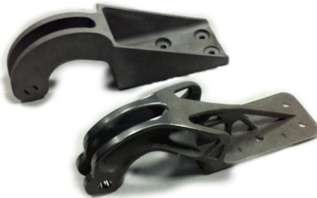
Figura 1. Bisagra de metal utilizada en aviones, diseño anterior para maquinado (atrás); el rediseño, empleando optimización topológica (frente), ofrece la misma resistencia con la mitad del peso. Cortesía de EADS para Wohler Associates, Inc. [1]
