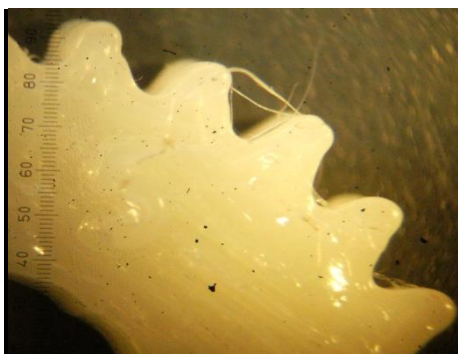
Engrane 5, 1 Contorno Filamentos finos 0.305mm Air gap: -0.05
