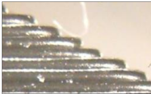
Figura 34. Efecto de escalonamiento en las construcciones FDM.
