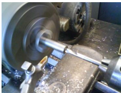
Figura 5.2. Maquinado en torno de los rodillos.
