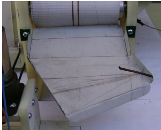
Figura 5.21. Rampa de salida para residuos no clasificados.
