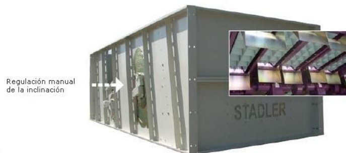
Figura 2.4. Separación mediante tamizado [9].
