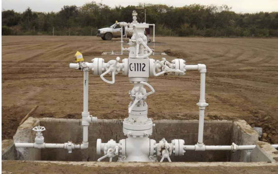
Figura 3.6: Árbol de Válvulas de un pozo con BNI en el campo TC 4 .
