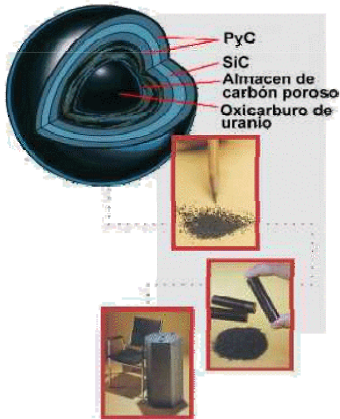
Figura 1.14. Combustible de partículas revestidas. [15]
