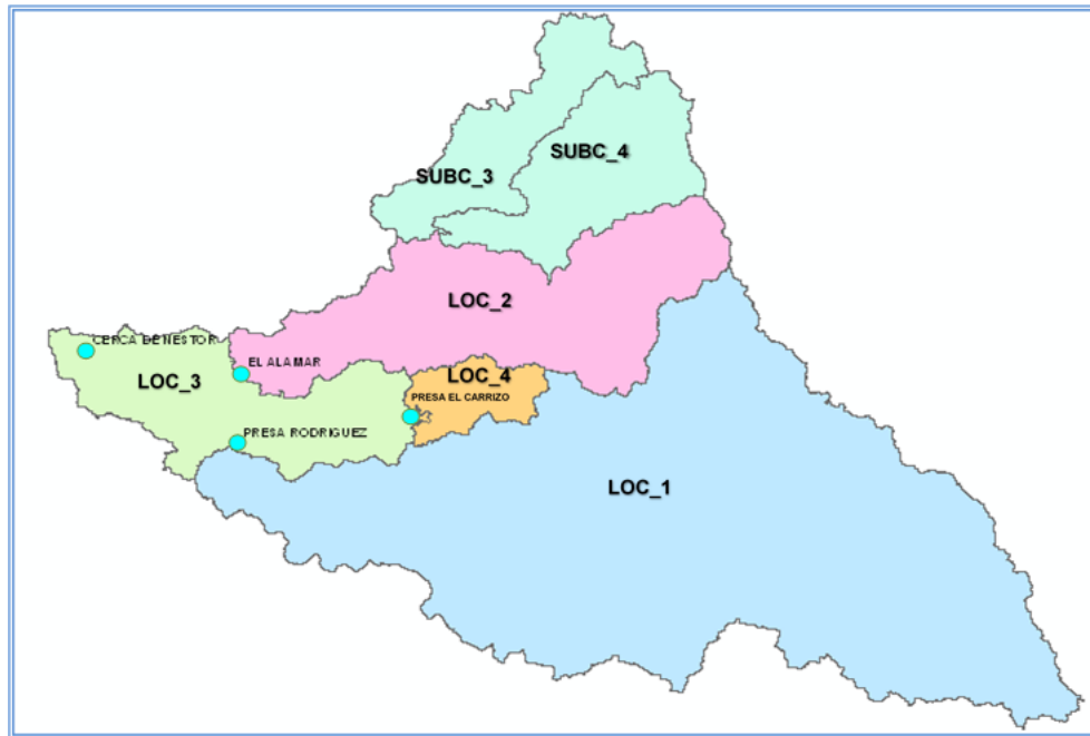
Figura 4.22 Localidades en que se dividió la Cuenca del Río Tijuana para cálculo de los coeficientes de escurrimientos
