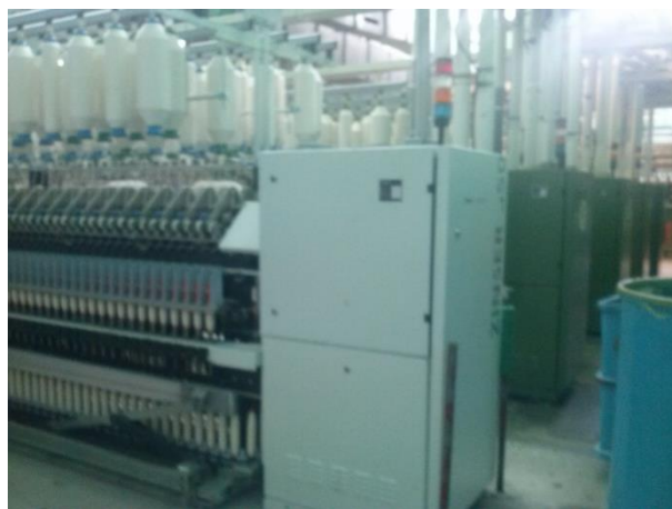
Figura 3.6 Torzales, maquinaria que realiza el hilado de las cintas cardadas de algodón. Fotografía capturada por la autora.
