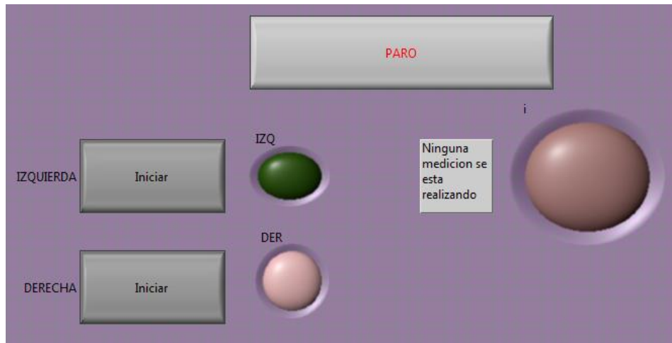
Fig. 69 Interfaz de calibración. Hay dos botones los cuales indica la posición a sensar, esta es elegida por el usuario experto. Maya A, Acosta. 2013.
