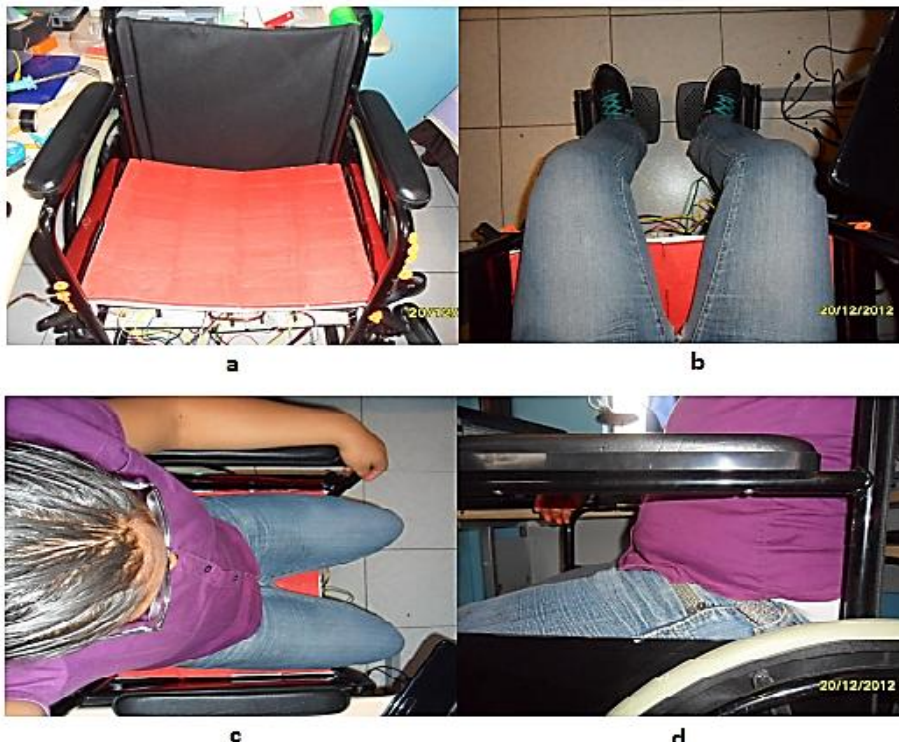
Fig.47. a) Vista superior en donde se logra apreciar el arreglo de plastilina, b) Durante la prueba se hizo uso del reposapiés, c) Vista superior durante la prueba, se puede percibir la postura que se adoptó durante la prueba y d) durante la prueba la postura fue sedente con la espalda totalmente recargada en el respaldo de la espalda. Maya A, Acosta. 2012.
