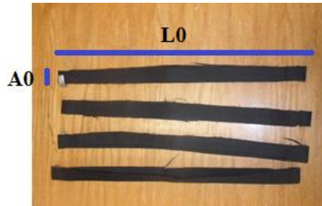
Fig. 46. Imagen en donde se puede observar la sección longitudinal (L0) y la sección transversal (A0). Maya A, Acosta. 2013.
