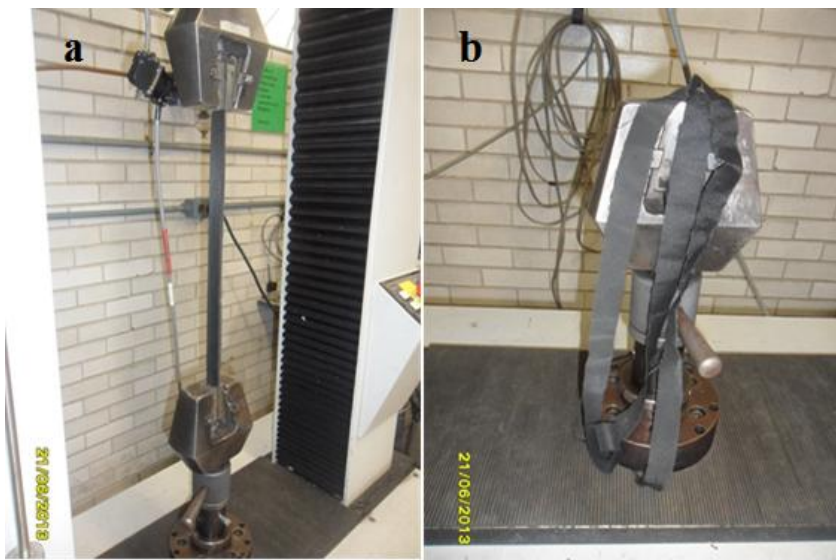
Fig. 44. a) Tira de polyester tensionada durante el ensayo de tensión. b) Tira de polyester una vez terminado el cuarto evento de la prueba. Maya A, Acosta. 2013.
