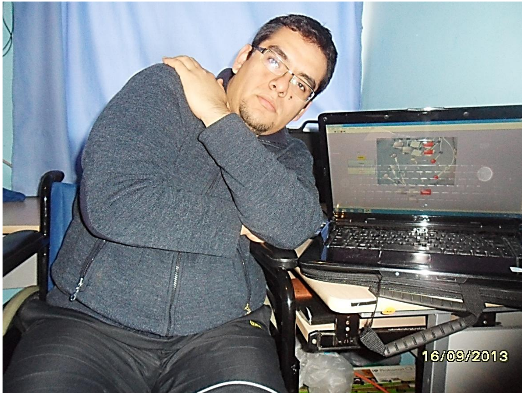
Fig. 74. Usuario adoptando la Posición Izquierda, a la derecha de la imagen podemos ver los cuadrantes C2 y C3 encendidos e indicando dicha postura. Maya A, Acosta. 2013.
