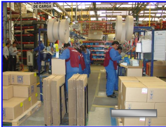
Figura 48. Nueva línea de ensamble Centros de Carga (2)
