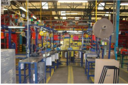
Figura 43. Línea de ensamble Centros de Carga
