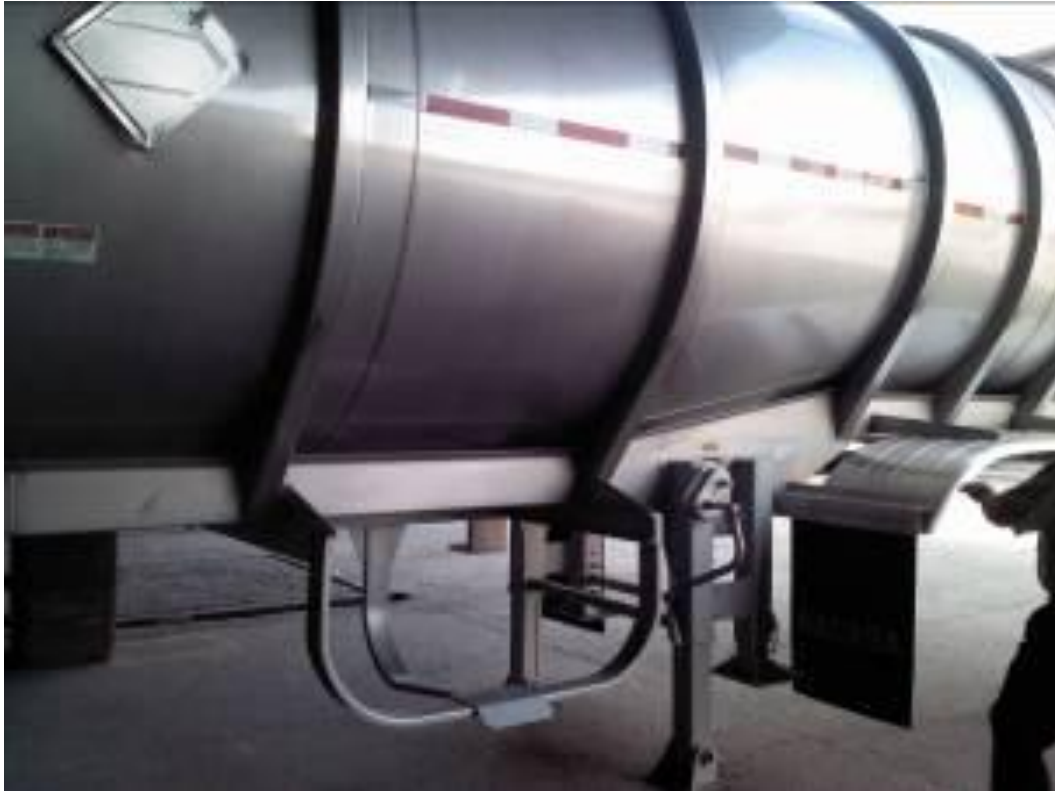
Figura 4.3. Vista de autotankero SCT 306 doble cónico donde se aprecia el señalamiento con rectángulos reflectantes (cuadros blancos y rojos), así como el rombo de identificación.
