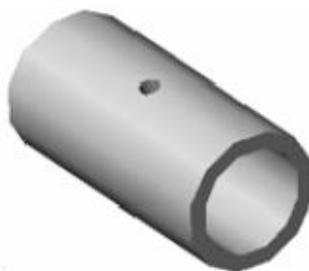
*Imagen III.III. Cojinete de deslizamiento*
