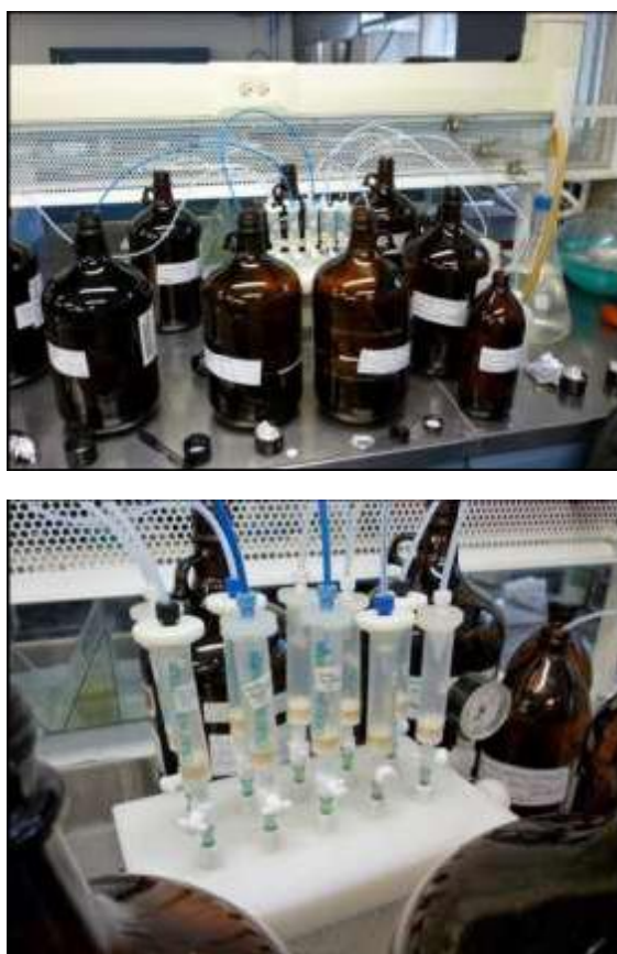
Figura 10. Filtrado de muestras de agua del proceso de extracción de compuestos orgánicos por cartuchos Oasis® HLB.
