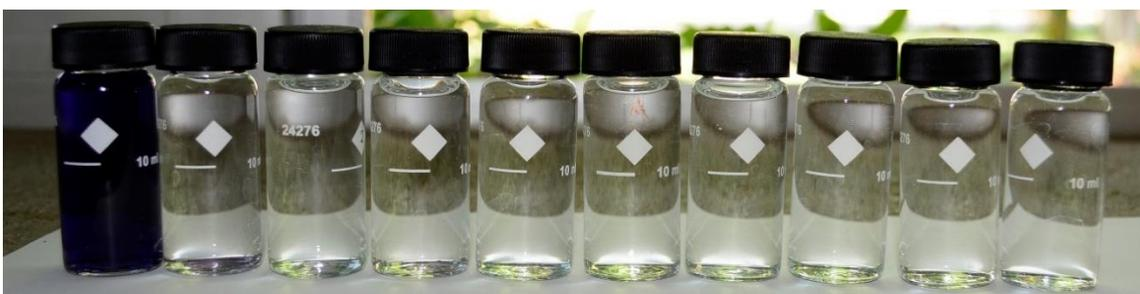
**Figura 4.56.** Seguimiento visual (Bloque 33) para la decoloración (AD2) para el chayote, con una concentración inicial de 60 mg/L.
