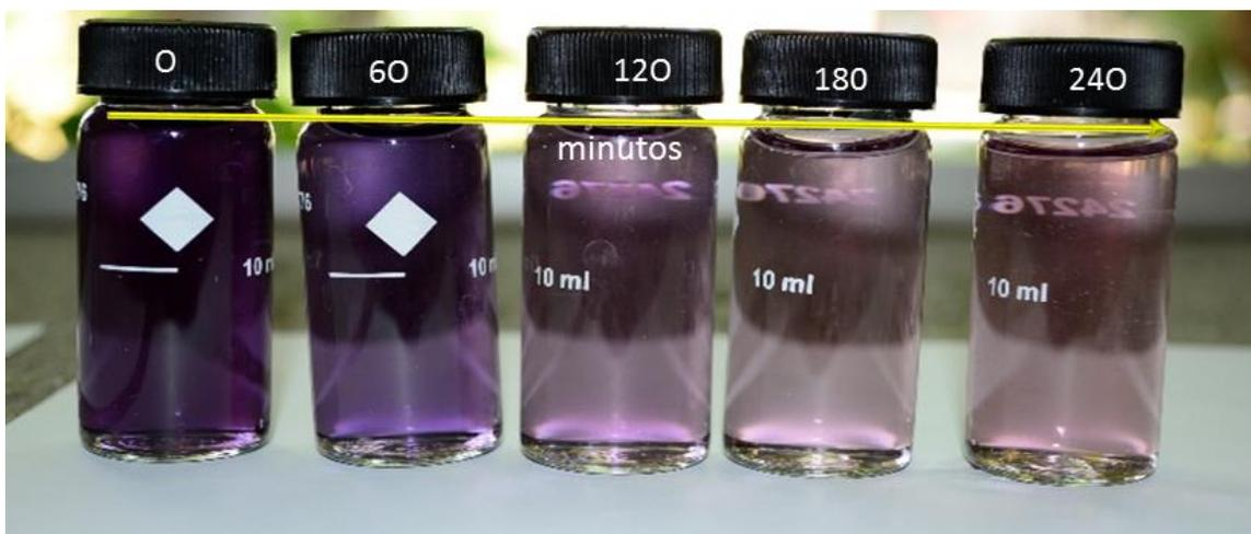
**Figura 4.45.** Seguimiento visual tomadas a diferentes intervalos de tiempos durante 240 min (Bloque 12) para la decoloración del colorante azul directo 2 con la enzima peroxidasa del residuo industrial de soya se obtuvo un 38.9% de decoloración en 4 h, con 37.5°C, con una concentración de enzima de 1500 µL y de peróxido de 1500 µL, a pH de 5.5 con una concentración inicial de 35 mg/L de colorante.
