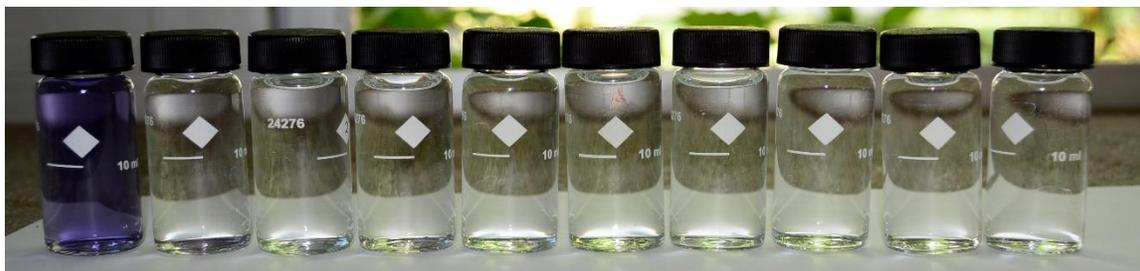
**Figura 4.55.** Seguimiento visual (Bloque 2) para la decoloración (AD2) para el residuo industrial de soja, con una concentración inicial de 10 mg/L.
