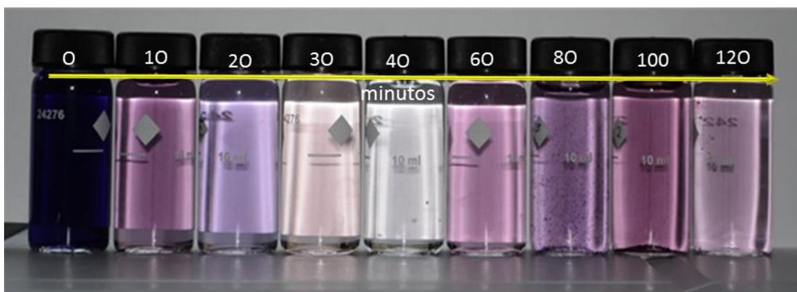
**Figura 4.40.** Seguimiento visual tomadas a diferentes intervalos de tiempos durante 120 min (Bloque 30) para la decoloración del colorante azul directo 2 con la enzima peroxidasa del residuo industrial de soya en donde se obtuvo un 51.7% de decoloración en 2 h, con 50°C, con una concentración de enzima de 1000  $\mu\text{L}$  y de peróxido de 2000  $\mu\text{L}$ , a pH de 3.5 con una concentración inicial de 60 mg/L de colorante.
