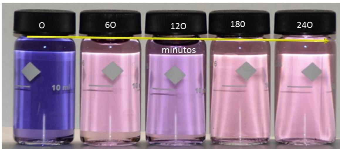
**Figura 4.46.** Seguimiento visual tomadas a diferentes intervalos de tiempos durante 240 min (Bloque 37) para la decoloración del colorante azul directo 2 con la enzima peroxidasa del residuo industrial de soja se obtuvo un 70.5% de decoloración en 4 h, con 37.5°C, con una concentración de enzima de 1500  $\mu\text{L}$  y de peróxido de 1500  $\mu\text{L}$ , a pH de 5.5 con una concentración inicial de 35 mg/L de colorante.
