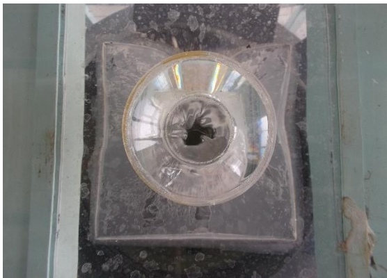
Ilustración 5.22 Estrías formadas en el flujo sobre un vertedor de embudo Q = 1.42 l/s.
