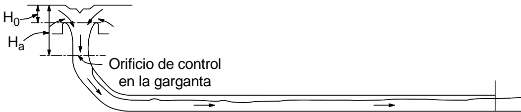
b. Descarga ahogada, pero zona aireada en el túnel de descarga.
