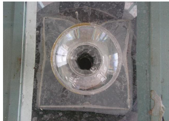
Ilustración 5.23 Flujo en gasto máximo seleccionado Q = 1.26 l/s.
