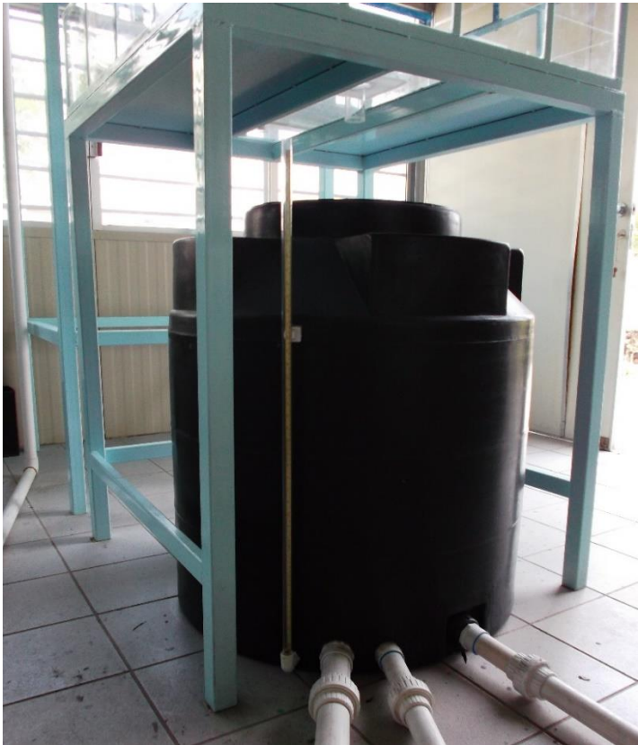
Ilustración 5.4 Limnómetro y depósito para efectuar mediciones de caudal
