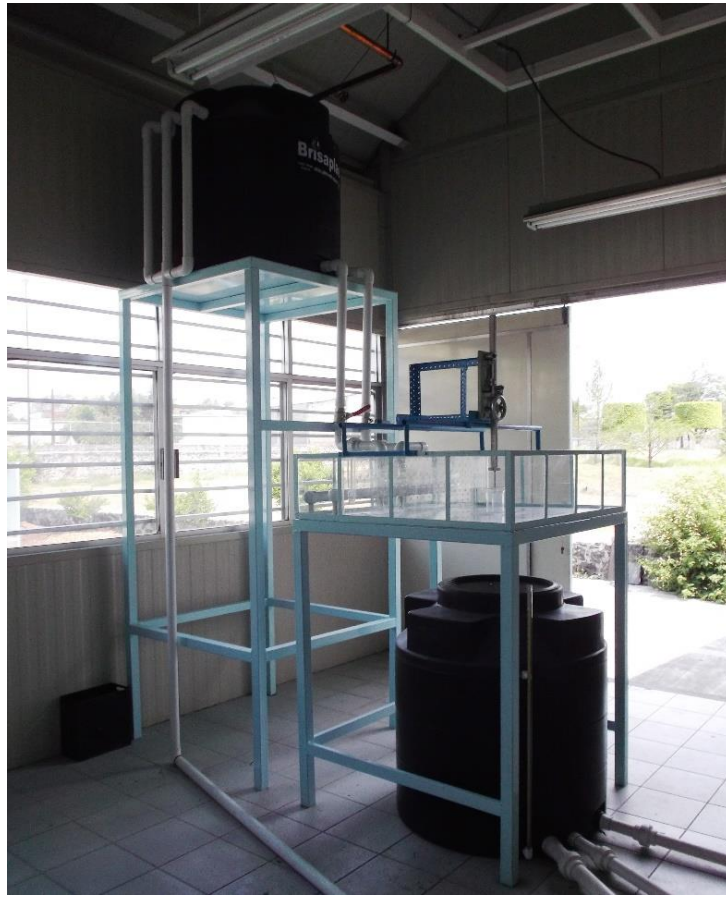
Ilustración 5.2 Mesa de laboratorio para efectuar pruebas hidráulicas en vertedor de embudo
