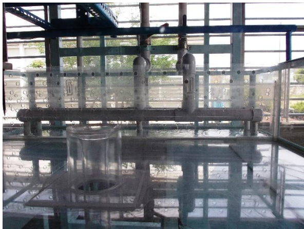
Ilustración 5.13 Tranquilizador con flujo desbalanceado
