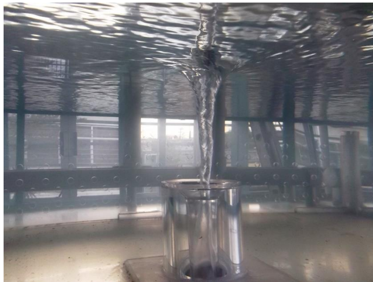
Ilustración 5.12 Vórtice completamente desarrollado
