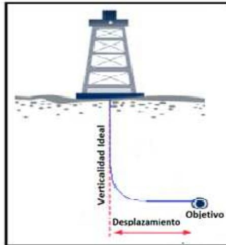
Fig. 10.- Trayectoria Horizontal. Recuperado de (figura modificada de <http://www.pdvs.com>).
