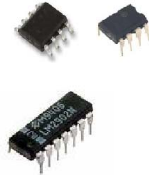
Figura 4-13. Representación de un amplificador operacional y los encapsulados más comunes.
