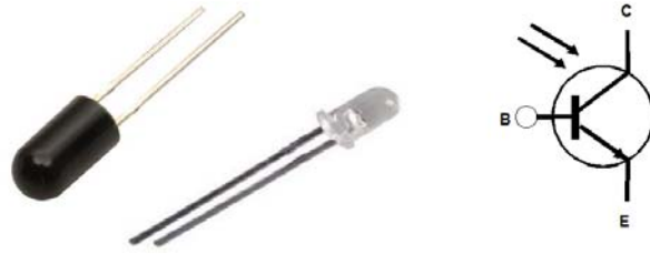
Figura 4-12. Fototransistores y su representación.
