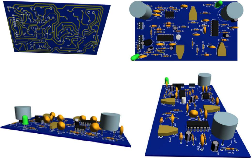
**Figura A-3.** Detector de presencia.
