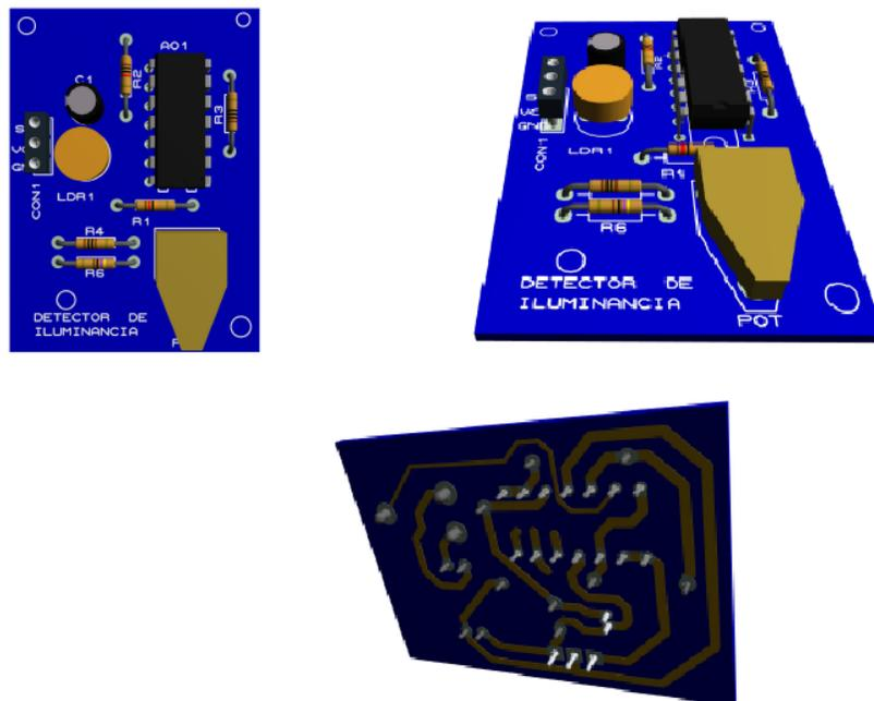
**Figura B-2.** Detector de nivel de iluminación.
