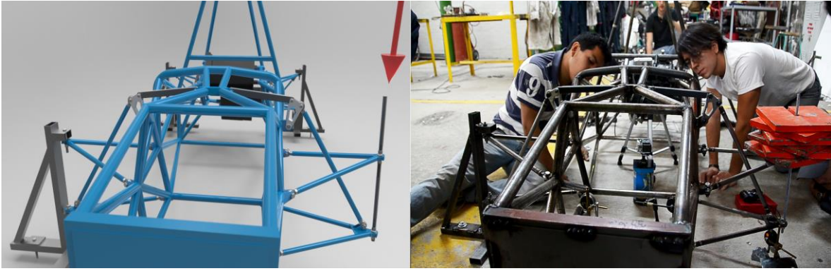
Fig 2.18 Las pesas de 10 Kg. se apilan alrededor del espárrago mientras se observa el desplazamiento del chasis
