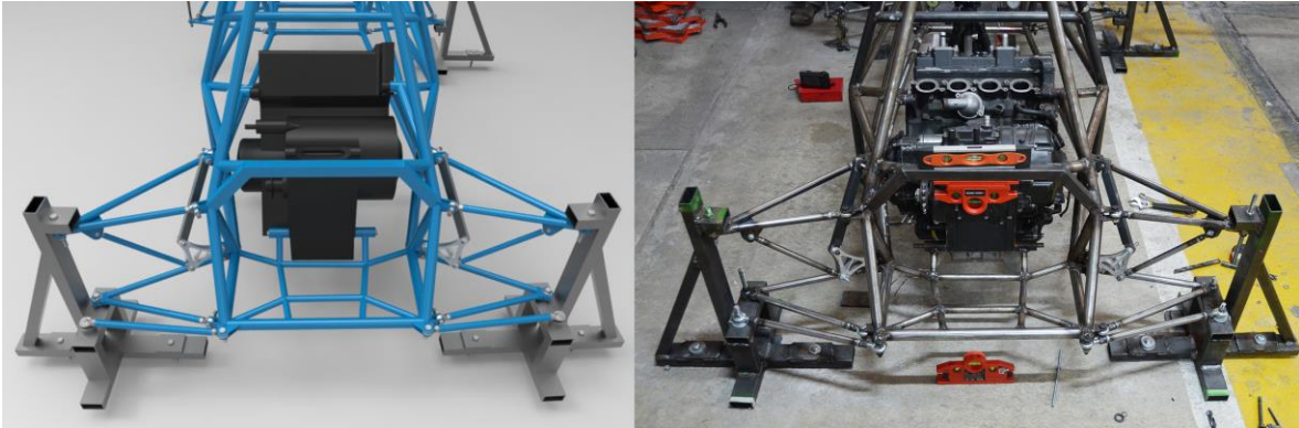
Fig 2.16 Configuración de la suspensión trasera. A la derecha se observa el ajuste del nivel del ensamble
