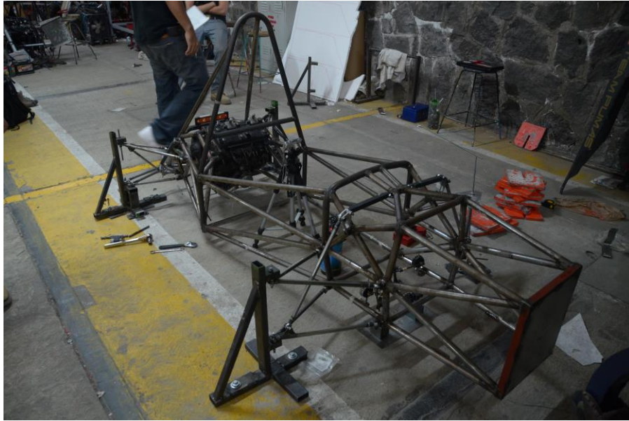
Fig 3.17 Configuración para la prueba de rigidez torsional del chasis UM-524
