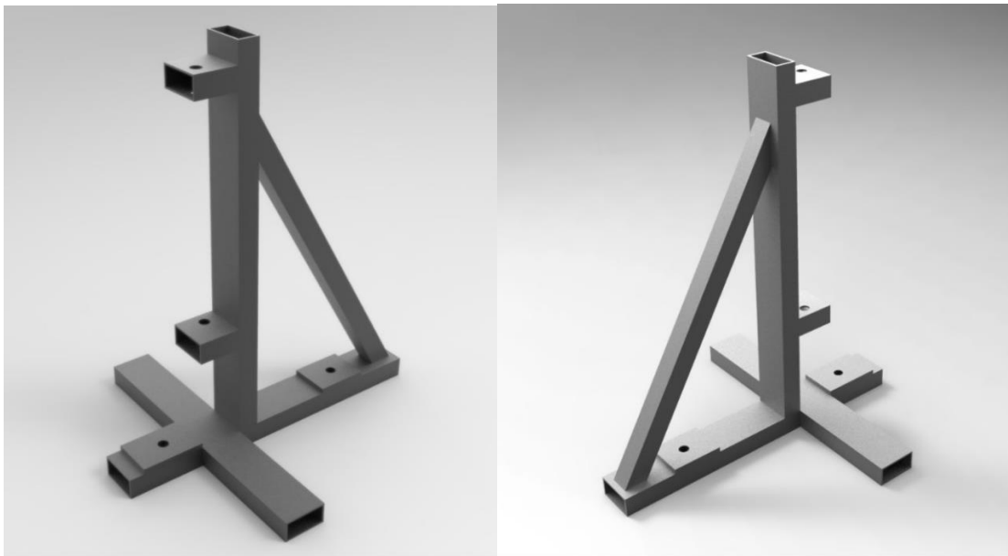
Fig 2.9 Diseño de soportes de la suspensión delantera (se muestra el derecho únicamente)
