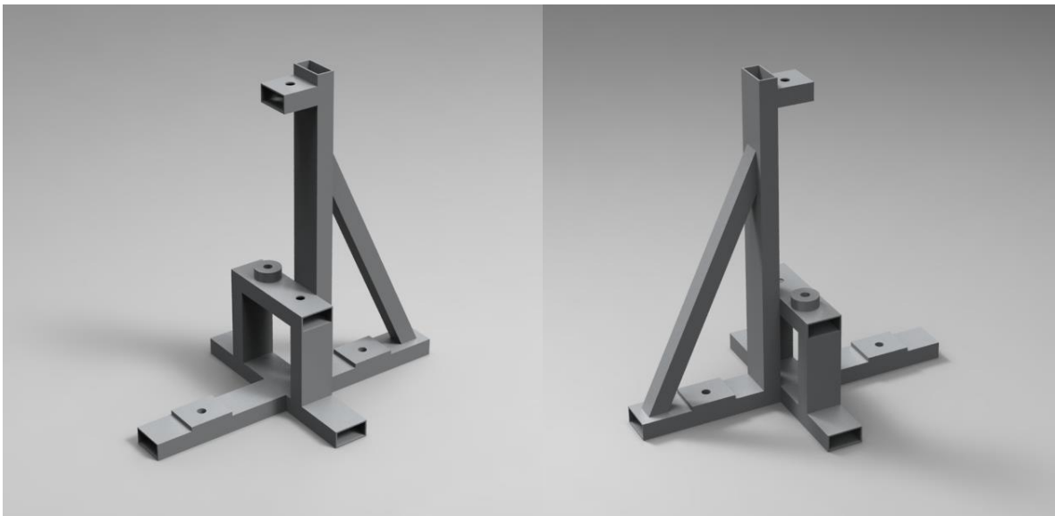
Fig 2.7 Diseño de soportes de la suspensión trasera (se muestra el derecho únicamente)
